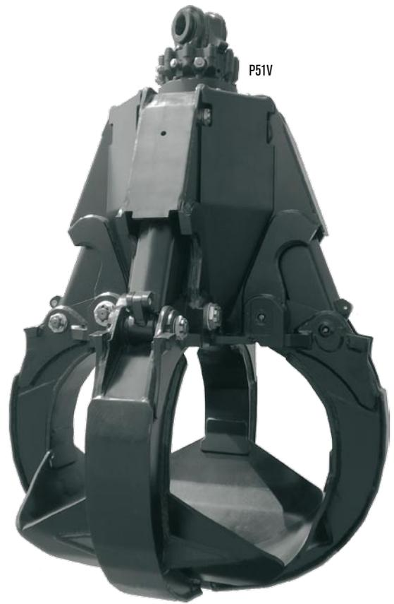
**Mehrschalengreifer mit 4 Greifarmen und einem Füllinhalt von 0,8 m<sup>3</sup> oder 1,0 m<sup>3</sup> für den Umschlag von sperrigen Gütern mit Maschinen bis 40 t bzw. 50 t Dienstgewicht**
